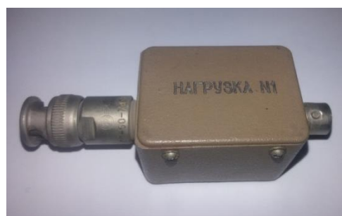
Рис. 4.1. Схема (а) и внешний вид (б) нагрузки для генератора Г5-60
